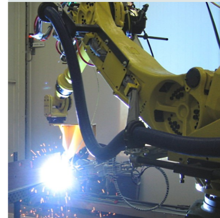
Tôlerie industrielle (56) Projet d'amélioration de la productivité pour des moyens de soudage robotisés existants
